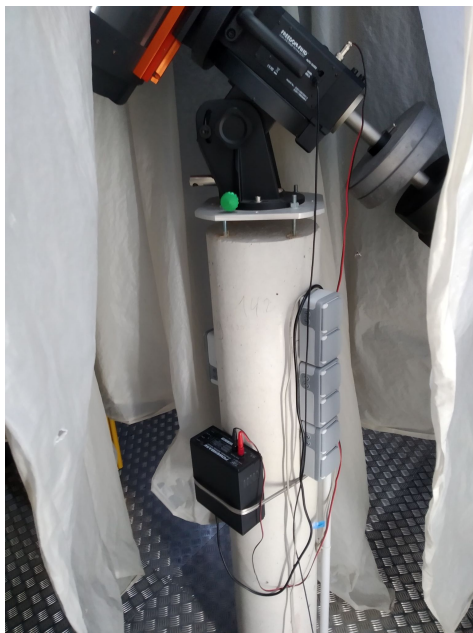
FIGURE 9 – La monture du télescope et son alimentation sur le poteau central en béton avec les divers câbles de connexion qui descendent vers le plancher amovible.
